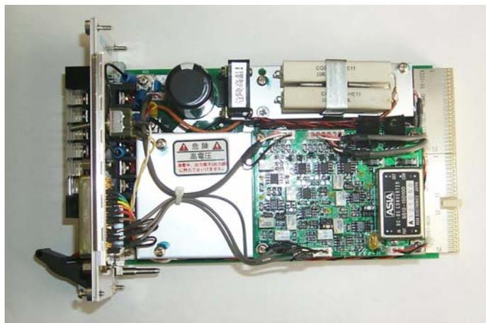
外部からの制御によるピエゾドライブ用コントロール電源です。
