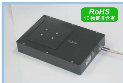
ピエゾアクチュエータを駆動源としストローク 1500 $\mu\text{m}$  を発生します。一体弾性ヒンジにより高速かつ高精度な位置決めが可能。変位センサー内蔵タイプはピエゾコントローラーと組み合わせることで極めて高精度な位置決めが可能です。
