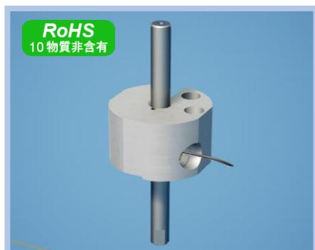
ピエゾシャフトクランパーは電圧印可によりスライド軸や回転軸をクランプします。無通電ではクランプ保持されます。頻繁にクランプ・アンクランプする箇所、手の届きにくい個所でのシャフト固定に適します。
