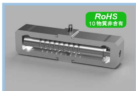
一体弾性ヒンジによるガイド機構に耐湿型の積層圧電アクチュエーターを組込んだ製品で摩擦のない精度のよい真直動作。変位拡大により小型ながら大きな変位量が発生。サブナノメートルオーダーの高分解能動作と高速応答性。各種機器への組込みに特化した低コストタイプ
