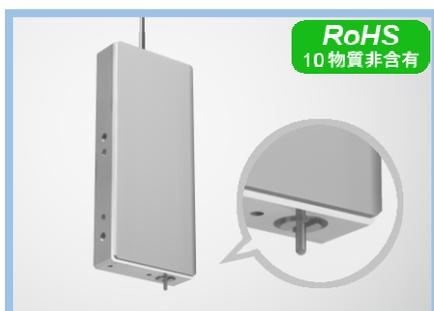
積層圧電アクチュエーターにより可動ピンを高速変位させます。一体弾性ヒンジの変位拡大機構により小型ながら大きな変位量が発生。サブナノメートルオーダーの高分解能動作とサブミリ秒の高速応答。各種機器への組込みに特化した低コストタイプ。
