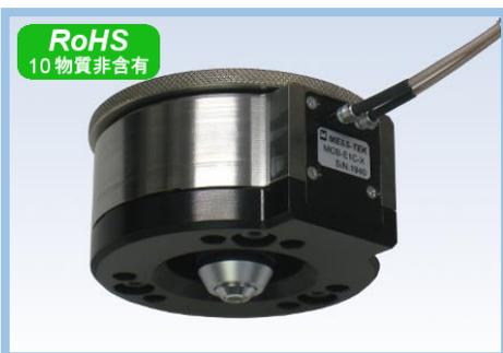
対物レンズを光軸方向に移動させることでフォーカス調整することができます。ピエゾ素子により高分解能・高速な位置決めが可能です。弾性案内機構を採用しており摩擦・摩耗する箇所がありません。長期にわたり精度が安定でメンテナンスが不要です。各種顕微鏡・対物レンズに合わせたねじアダプタをご用意しており簡単に取付けできます。変位センサー内蔵タイプはクロズドピエゾコントローラーと組合せることで極めて高精度・高安定な位置決めが可能です。
