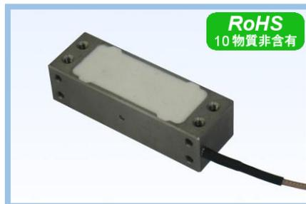
一体弾性ヒンジによるガイド機構に積層圧電アクチュエーターを組み込んだ製品で摩擦のない精度のよい真直動作。変位拡大により小型ながら大きな変位量を発生。サブナノメートルオーダーの高分解能動作とミリ秒高速応答性。各種機器への組み込みに特化した低コストタイプ
