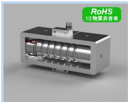
一体弾性ヒンジによるガイド機構に耐湿型の積層圧電アクチュエーターを組込んだ製品で摩擦のない精度のよい真直動作。変位拡大により小型ながら大きな変位量を発生。サブナノメートルオーダーの高分解能動作と高速応答性。各種機器への組込みに特化した低コストタイプ
