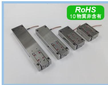
一体弾性ヒンジによるリニアガイド機構に積層圧電素子を内蔵したユニットです。高剛性・高速応答・真直度・小型。ストロークは 20 $\mu$ m ~120 $\mu$ m を選択できます。静電容量型変位センサ・温度センサ・空気導入継ぎ手をオプション設定。
