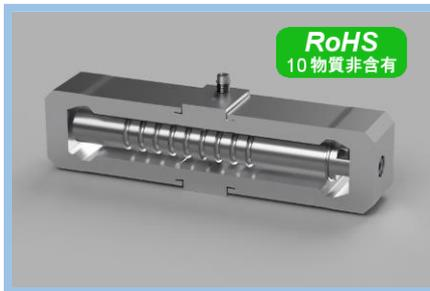
一体弾性ヒンジによるガイド機構に耐湿型の積層圧電アクチュエーターを組込んだ製品で摩擦のない精度のよい真直動作。変位拡大により小型ながら大きな変位量を発生。サブナノメートルオーダーの高分解能動作と高速応答性。各種機器への組込みに特化した低コストタイプ
