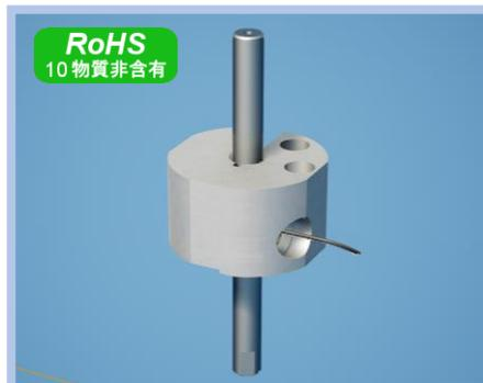
ピエゾシャフトクランパーは電圧印可によりスライド軸や回転軸をクランプします。無通電ではクランプ保持されます。頻りにクランプ・アンクランプする箇所、手の届きにくい個所でのシャフト固定に適します。
