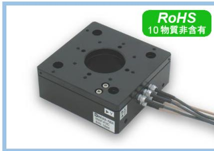
透過窓φ30mm付き3軸ピエゾステージ。変位拡大機構によりストローク180 $\mu$ mを発生。1軸・2軸・3軸タイプを選択可能。一体弾性ヒンジ機構の摩擦レス動作により移動精度が高い。変位センサー内蔵タイプはピエゾコントローラーと組合せて高精度な位置決めが可能。
