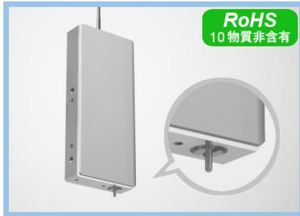
積層圧電アクチュエーターにより可動ピンを高速変位させます。一体弾性ヒンジの変位拡大機構により小型ながら大きな変位量が発生。サブナノメートルオーダーの高分解能動作とサブミリ秒の高速応答。各種機器への組み込みに特化した低コストタイプ。
