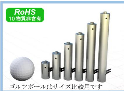
積層圧電素子をねじ穴付きケースに入れて予備圧縮力を与えた基本ユニットです。変位の際に押し引きの力を発生できます。低コスト・小型なので機器への組込みに適します。ストロークの20 $\mu$ m~120 $\mu$ mを選択できます。変位センサ・温度センサ・空気導入継ぎ手をオプション設定。
