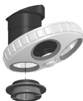
2. レボルバにねじアダプタを取付する
