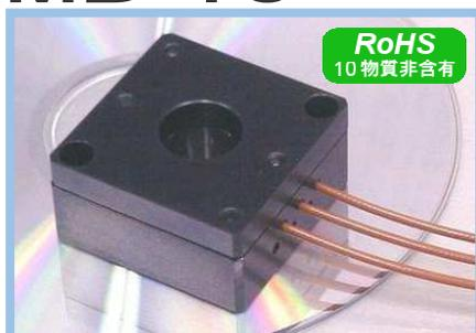
透過窓（φ15）付き小型3軸ピエゾステージ。1軸、2軸タイプも選択可能。一体弾性ヒンジ機構の摩擦レス動作により移動精度が高い。
