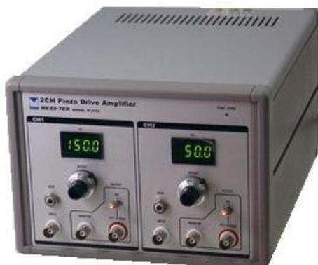
入出力が2CH独立なのでXY Piezoステージの駆動に最適
