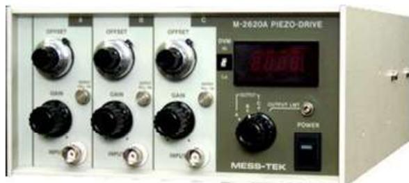
●超精密位置決め制御など、比較的**低速**でのピエゾアクチュエータ駆動に適しています。
